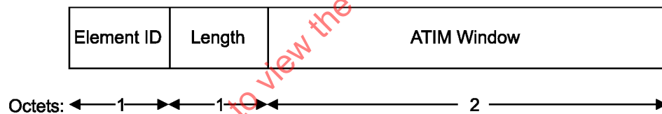
Figure 41—IBSS Parameter Set element format
