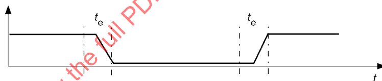
Figure 6c – Courbe avec signal continu à l'état «absence de tension»
